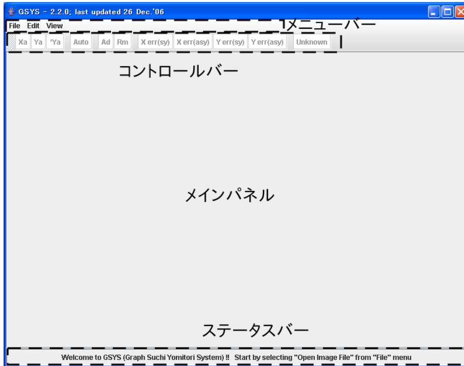
図 1: 起動直後の GSYS2.2 の画面。この状態では "File" メニューの "Load Image File" と "Edit" メニューの "Properties"、"View" メニューの "Show status bar" が選択可能になっています。
